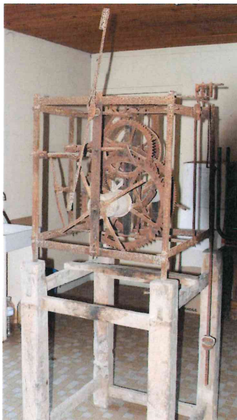
Mécanisme d'horloge-cage (cl. Claire Durand, CDAOA de Vendée)
