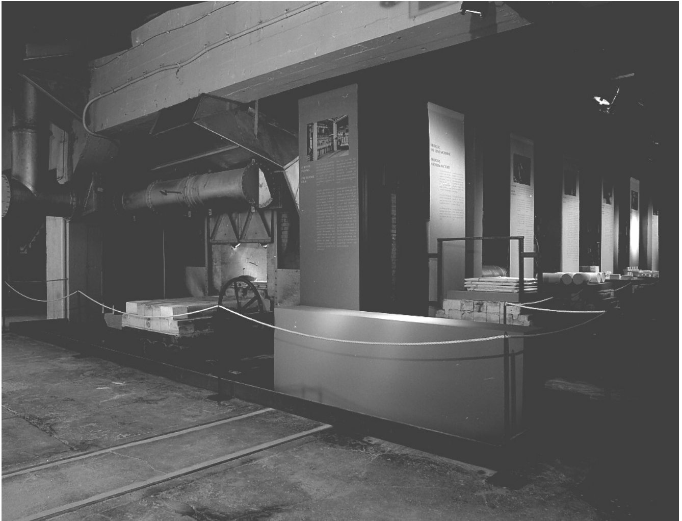
Fig.1 Partie Sud du four-tunnel, où se situe l'orifice destiné à l'introduction des wagonnets de porcelaine à cuire. A droite, la voie où sont stockés les wagonnets après cuisson, déchargement des pièces cuites puis chargement des pièces à cuire (exposition muséographique).
