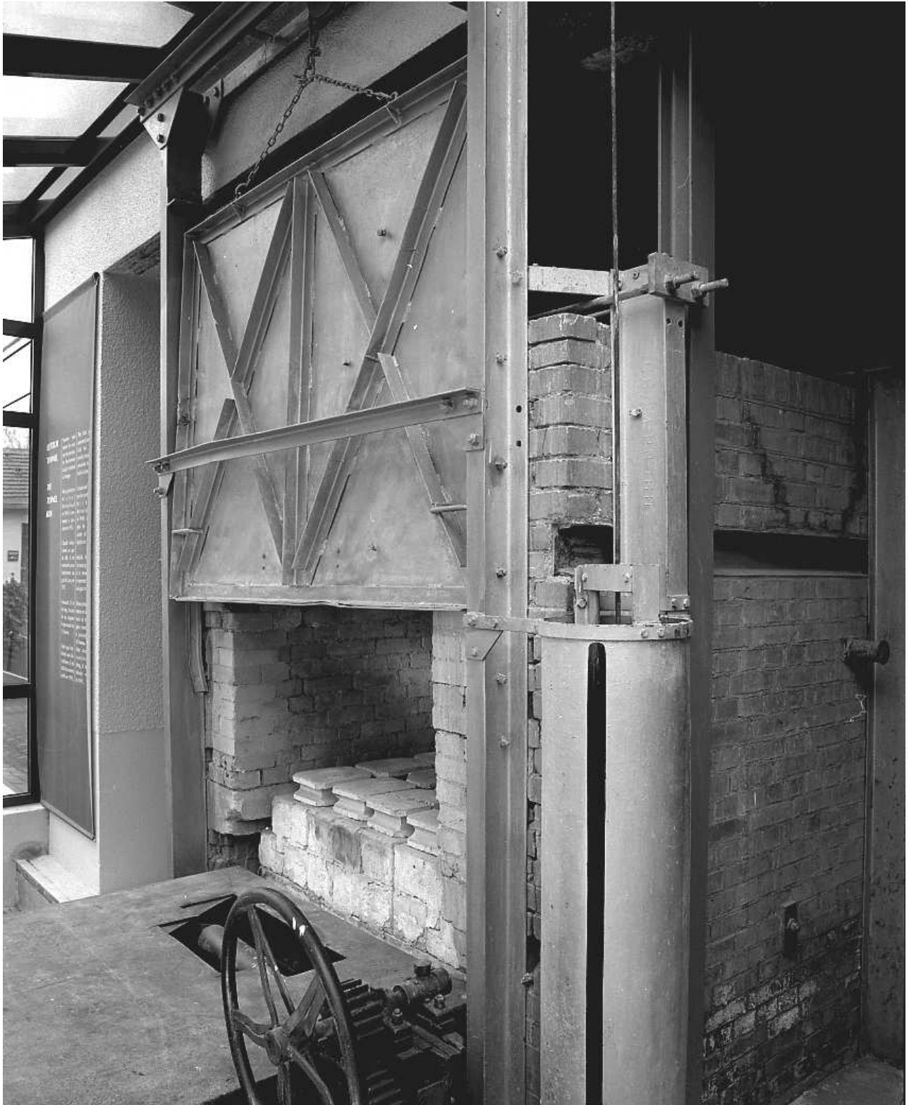
Fig.5 Orifice d'où sortent les wagonnets de porcelaine après cuisson. Au premier plan le mécanisme de translation pour déplacer les wagonnets et les positionner latéralement au four.
